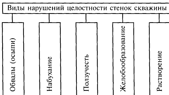
Рис. 8.4. Классификация нарушений целостности стенок скважины
